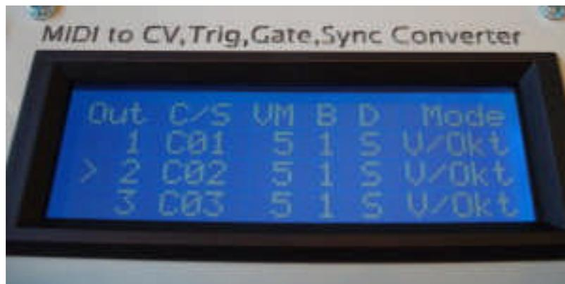
Dank dem vierzeiligen, hintergrundbeleuchteten Display profitieren Sie einerseits von einer übersichtlichen Darstellung und andererseits von einer sehr einfachen Menüführung, die mit lediglich 4 Tasten auskommt.
