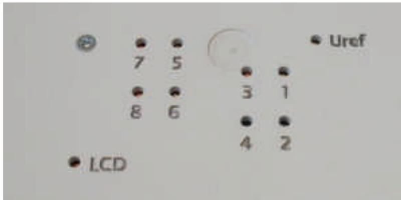
Die Trimmer erreichen Sie über Bohrungen mit einem sehr schmalen Flachkopfschraubendreher, die entsprechend der Ausgänge von 1 bis 8 durchnummeriert sind.
