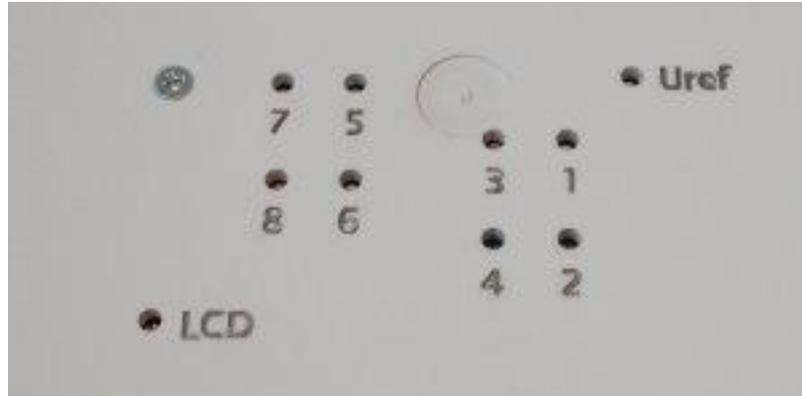
Die Potentiometer erreichen Sie über Bohrungen mit einem sehr schmalen Flachkopfschraubendreher, die entsprechend der CV Ausgänge von 1 bis 8 durchnummeriert sind.
